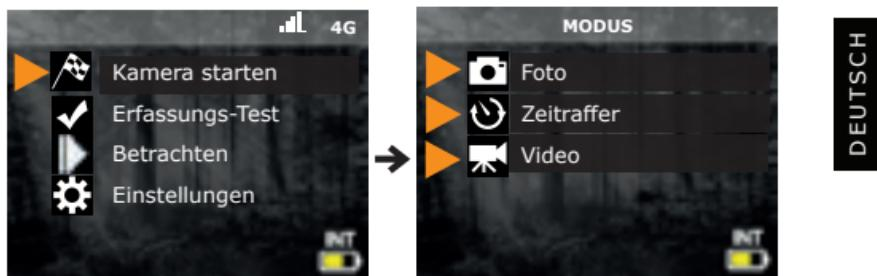
Klicken Sie auf Kamera starten und wählen Sie die gewünschte Betriebsart (Foto, Zeitraffer oder Video) im Modus-Menü durch Drücken der OK-Taste. Wenn Sie die Kamera im Videomodus starten, stellen Sie sicher, dass Sie die "Zusätzliches Bild"-Funktion aktiviert ist.
