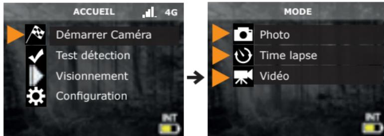
Selectionnez le mode d'opération désiré (photo, time lapse ou vidéo) dans le menu Mode en appuyant sur OK. Si vous démarrez la caméra en mode Vidéo, assurez-vous d'avoir activé l'option Photo prévidéo dans la configuration.
