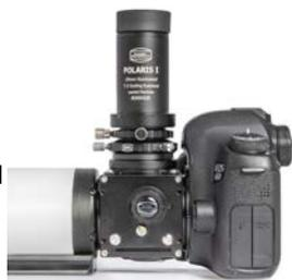
Über einen handelsüblichen T-Ring oder einen M48-Adapter können Sie Ihre Kamera anschließen. Auch Spektrographen wie der DADOS können für die kürzestmögliche Verbindung direkt an den FlipMirror geschraubt werden. Entfernen Sie dazu einfach die 2"-Steckhülse des Spektrographen.
