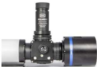
Das Polaris Fadenkreuzokular, direkt angeschlossen über die variable 12-16 mm T-2-Verlängerung. Die Kamera rechts wurde mit einer 15mm-T-2-Hülse auf den notwendigen Arbeitsabstand gebracht.
