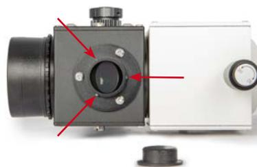
Die untere Anschlussplatte. Die roten Pfeile markieren die Befestigungsschrauben für das Prismenmodul eines Off-Axis-Guiders. Mit den Innensechskantschrauben kann die Ansatzplatte entfernt werden, für den Anschluss einer Kalibrierlampe. Im Inneren des BFM II ist die maskierte Rückseite des Spiegels zu erkennen.
