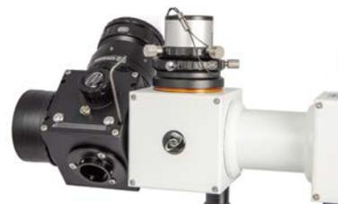
Die Anschlussgewinde sind über die vier Madenschrauben verstellbar. So kann Zubehör wie hier der DADOS-Spektrograph bündig auf das Gehäuse ausgerichtet werden, oder der ganze Ansatz verdreht werden, falls er fest mit dem Teleskop verschraubt ist.
