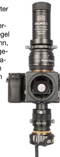
Off-Axis-Guidler unten am BFM II. Das Prisma schaut immer unter dem Spiegel hindurch.
