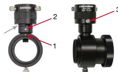
Um die Prismeneinheit des Baader Off Axis Guidler für RCC (links) oder älterer Celestron Radial Guidler zu verwenden, müssen Sie zuerst die T-2-Hülse entfernen, indem Sie die Schraube 1 lösen. Öffnen Sie dann die beiden Schrauben 2, um den Zwischenring zu entfernen (grauer Pfeil), und befestigen Sie die Prismeneinheit wieder an der Okularhalterung. Die Schraube 3 dient zum Kippen des Prismas.
