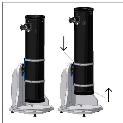
Abbildung B. Den Schwalbenschwanz nach unten und den Tubus nach oben schieben!
