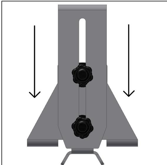
Figure 2. Deslize o suporte triangular.
