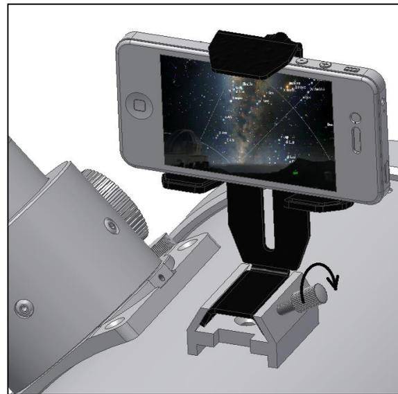
Figure 5. Deslize a base na base do buscador do tipo Vixen, Certifique-se que o parafuso lateral está apertado.
