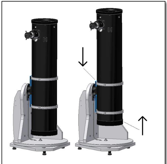
Abb 19. Den Schwalbenschwanz nach unten und den Tubus nach oben schieben!
