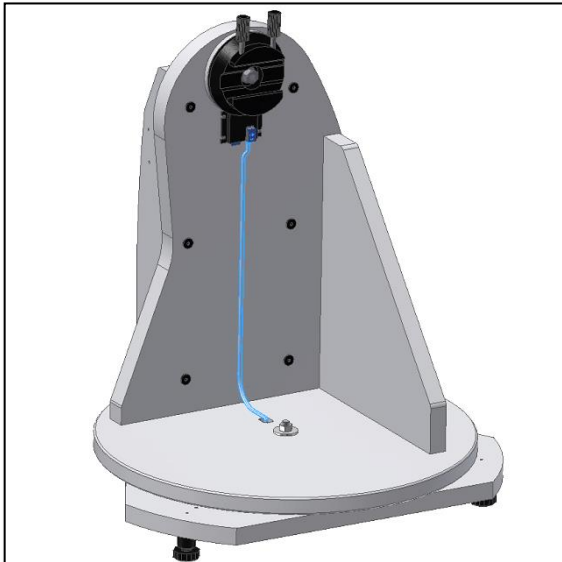
Abb 15. Das mitgelieferte Kabel (Teil 4) installieren. Beim Verbinden der Anschlüsse rasten diese hörbar ein.
