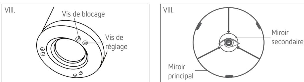
**Conseil :** Pour la collimation il est préférable de faire un marquage au milieu du miroir principal. Cela facilite la collimation. Utiliser de préférence un oculaire de collimation Chesire ou un laser de collimation pour régler votre télescope.
