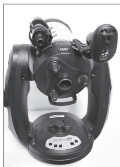
Chercheur et StarSense installés sur CPC800
