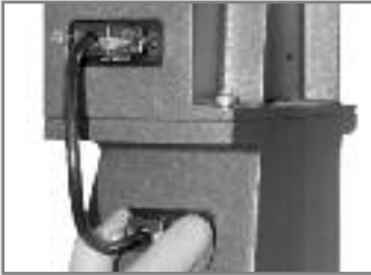
Abb. 54: Verbinden der DB-9 Buchsen mittels der 20cm langen Kabel.
