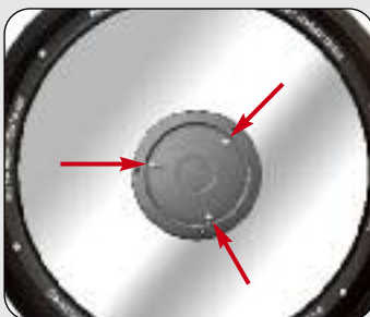
Abb. 57: Die Kollimation erfolgt über die drei inneren Inbusschrauben.
