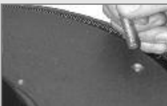
Abb. 47: Entfernen Sie die Spitzschrauben aus dem Sockel.
