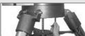
Abb. 48: Befestigen des Sockels auf dem Stativkopf.
