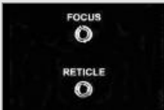
Abb. 56: Die Zubehör-Buchsen am linken Gabelarm des 14" LX200ACF.
