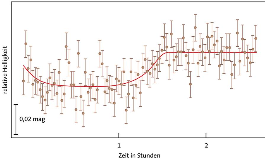
**Der Vorübergang des Exoplaneten Qatar-1b vor seinem Zentralstern führte zu einem Helligkeitsrückgang um rund 0,02 mag. Jedem Punkt der Lichtkurve entspricht eine 60 Sekunden belichtete CCD-Aufnahme am Celestron 11 Edge HD.**
